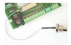
L'antenna standard (sx), di tipo speciale per le reti 3G, è costituita da una piattina dotata di strip per un eventuale fissaggio adesivo, e viene fornita già montata; l'antenna può essere staccata e ricollegata a pressione se si desidera sperimentare soluzioni d'antenna differenti.
