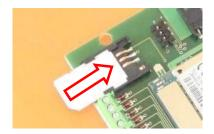
Un'altra condizione imprescindibile per l'uso del telecontrollo è costituita dall'inserimento dell'antenna gsm, che viene agganciata al net-edge tramite un apposito micro-connettore.
